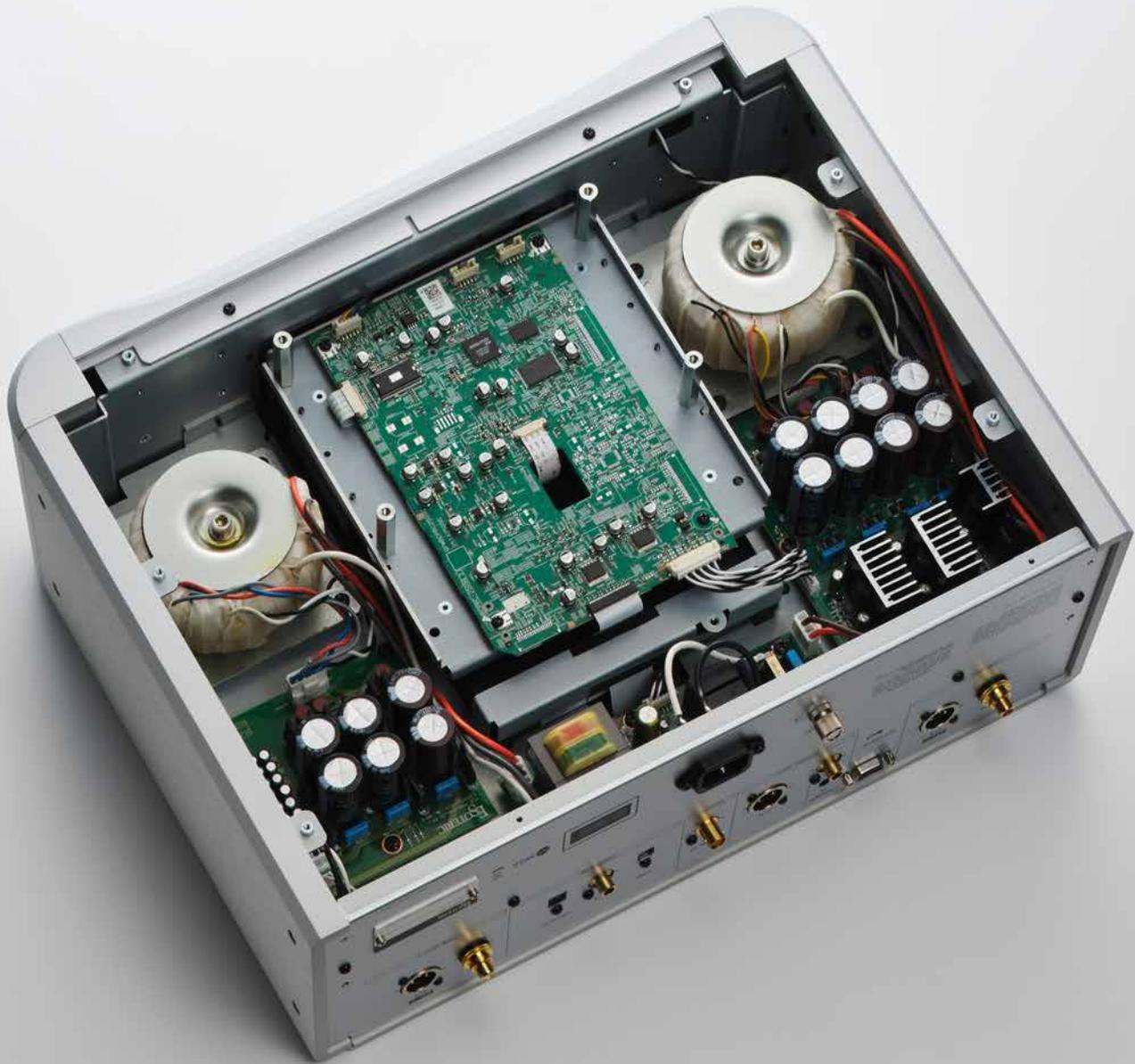
schneller rotierende SACD fehlerfrei abzutasten. Diese massive Einheit ist auf einer fünf Millimeter starken Stahlplatte montiert, die mittig auf der ebenfalls aus Stahl bestehenden Bodenplatte verankert ist. Beidseitig sind die separaten Netzteile mit den großzügig dimensionierten Ringkerntrafos fürs Analoge und Digitale untergebracht. Ein dritter EI-Trafo ist ausschließlich für die Steuerungseinheit zuständig. Das nenne ich eine konsequente Auseinandersetzung mit dem Thema Stromversorgung!
